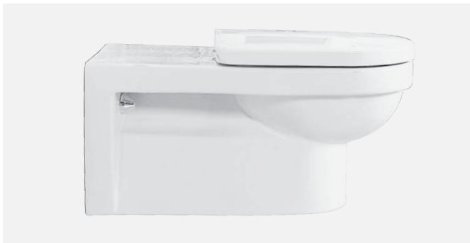
Das Wand-WC mit verlängerter Ausladung ist mit dem Rollstuhl überfahrbar und erleichtert das Übersetzen vom Rollstuhl auf das WC.
