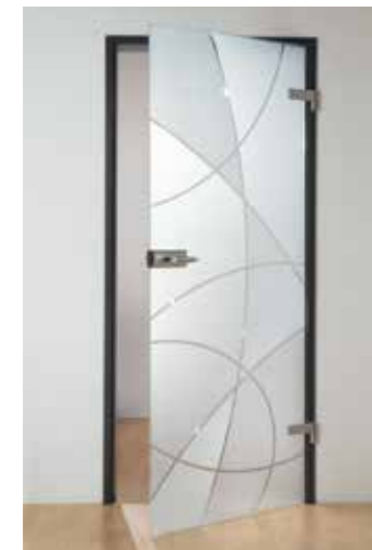
Melbourne ☺↔☑ Premiumtür in Weißglas mit 2-farbigem Siebdruck mattweiß und V-Rillenschliff 10 mm poliert, Hauptfläche milchweiß. Beschlag: Vogue SK01, Modell 154, Mattnickel-Chrom/Edelstahl
