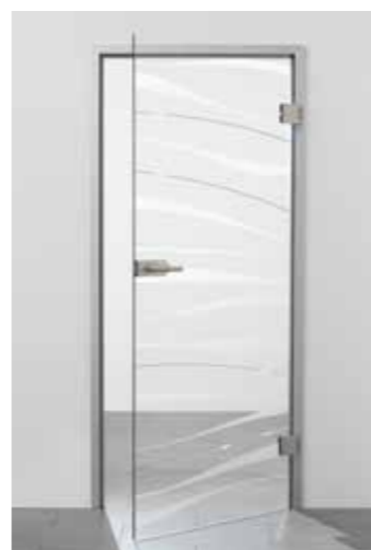
San Sebastian ☺↔☑ Premiumtür in Klarglas mit 1-farbigem Siebdruck mattweiß, Wellenlinien mit 4 x V-Rillenschliff 6 mm poliert. Beschlag: Vogue SK05, Modell 149, Edelstahl
