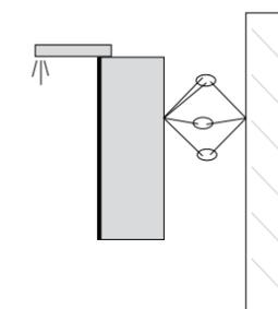
4-adriges Spiegelschrankkabel wird an 3-adriges Wandkabel angeschlossen. Dabei müssen 2 Leitungen auf einen Wandanschluss gelegt werden.
