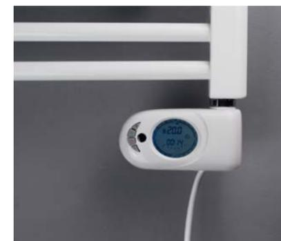
Digitale Regelbox mit der die Raumtemperatur automatisch und manuell, mittels + und - Taste oder über den Boost-Schalter für 1h bzw. 2h gesteuert werden kann. Durch einfaches aufstecken wird die digitale Regelbox mit dem »fast on« Adapter der Heizpatrone Typ 2 verbunden. 1m Kabellänge inkl. Schukostecker. Schutzklasse IP 44.
