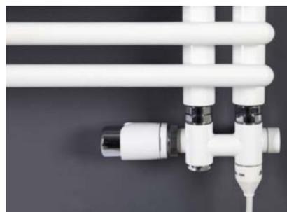
Kombi Ventilarmatur Eck für den Heizkörper HTO + HTT mit 50mm Nabenabstand. Diese Armatur bietet die Möglichkeit zusätzlich eine CHRISTESEN Heizpatrone für den Kombi-Betrieb zu installieren. Anschlüsse mit 3/4" Eurokonus, inkl. Thermostatkopf in der Farbe weiß RAL 9016.
