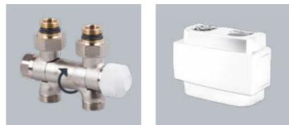
Universell einsetzbar für Eck- und Durchgangs-Ausführung durch 180° frei drehbarem Anschluss-Unterteil, absper- und entleerbar. Komplett mit Thermostatkopf und formschöner Abdeckblende in Farbe weiß RAL 9016 oder in verchromter Ausführung.
