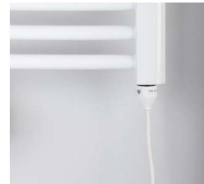
Elektro-Heizpatrone mit 1/2" Gewinde und integriertem Überhitzungsschutz. Kabellänge 1,2 m inkl. Schukostecker. Schutzklasse IP 64.
