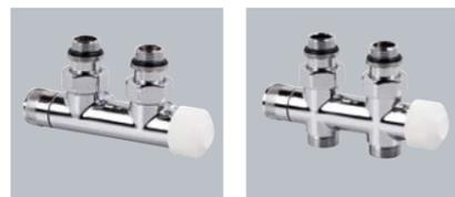
Design Ventilarmatur für 50 mm Nabenabstand, stufenlos voreinstellbar auf 10 verschiedene Positionen, selbstdichtende Anschlussnippel, rohreseitige Anschlüsse mit 3/4" Eurokonus, Vorlauf erfolgt immer rechts zum Hahnblock, inkl. Thermostatkopf in den Farben weiß RAL 9016, chrom, schwarz RAL 9005 matt und Edelstahl gebürstet.
